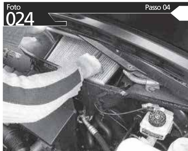
LEVANTE A CARENAGEM CUIDADOSAMENTE E FAÇA A TROCA DO FILTRO DE CABINE
