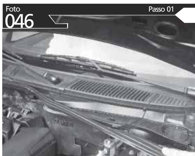
RETIRE A BORRACHA DE VEDAÇÃO
