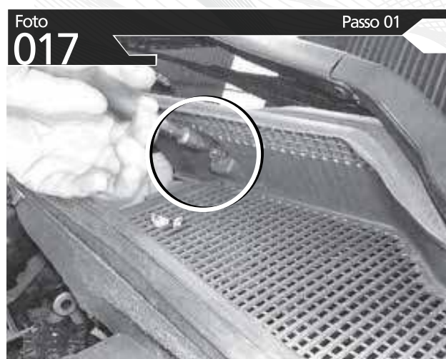
RETIRE TODOS OS PARAFUSOS DA CARENAGEM PLÁSTICA SOB O CAPÔ
