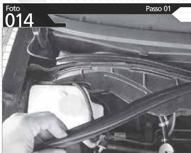
RETIRE A BORRACHA DE VEDAÇÃO SUPERIOR SITUADA AO CENTRO SOB O CAPÔ DO VEÍCULO
