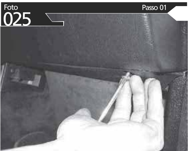
O FILTRO DE CABINE ESTÁ LOCALIZADO ABAIXO DO PORTA-LUVAS. RETIRE OS PARAFUSOS INDICADOS
