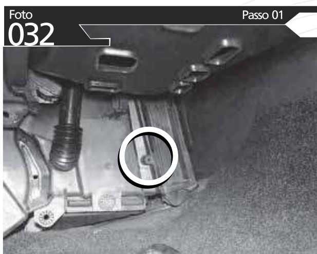
O FILTRO ESTÁ LOCALIZADO DO LADO DO CARONA NO CONSOLE CENTRAL. PUXE A TAMPA. LOCALIZE A TAMPA DO FILTRO E RETIRE OS PARAFUSOS QUANDO HOUVER
