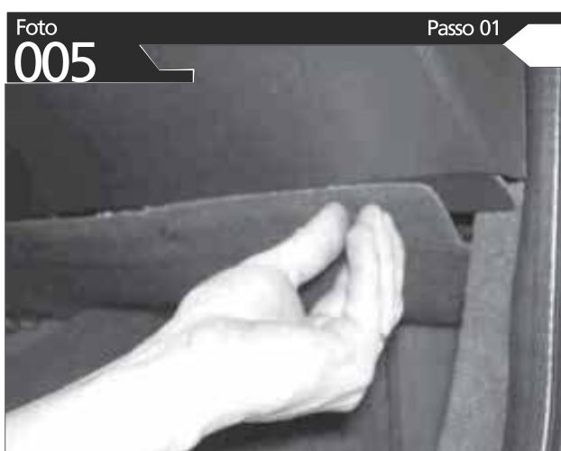
O FILTRO ESTÁ LOCALIZADO EM BAIXO DO PORTA-LUVAS. RETIRE AS TRAVAS
