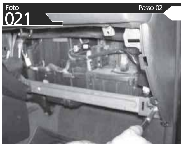
REMOVA A PROTEÇÃO DE FERRO
