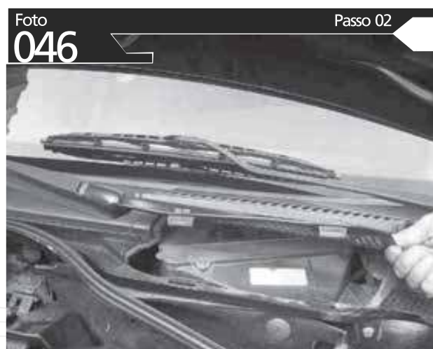
RETIRE A GRADE DE PROTEÇÃO
