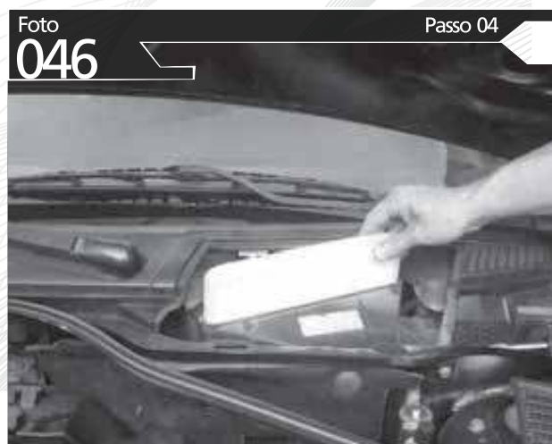
INSTALE O FILTRO E REPITA AS OPERAÇÕES
