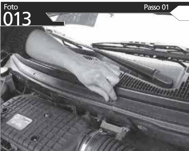
RETIRE PARAFUSOS DA CARENAGEM SITUADA AO LADO ESQUERDO DO CAPÔ
