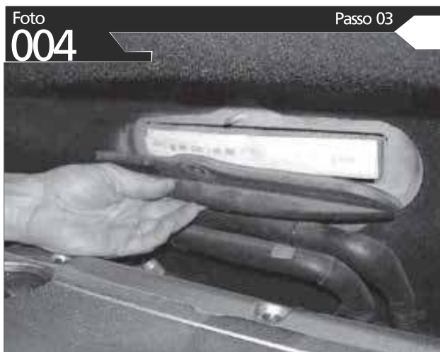
RETIRE A TAMPA DE PLÁSTICO
