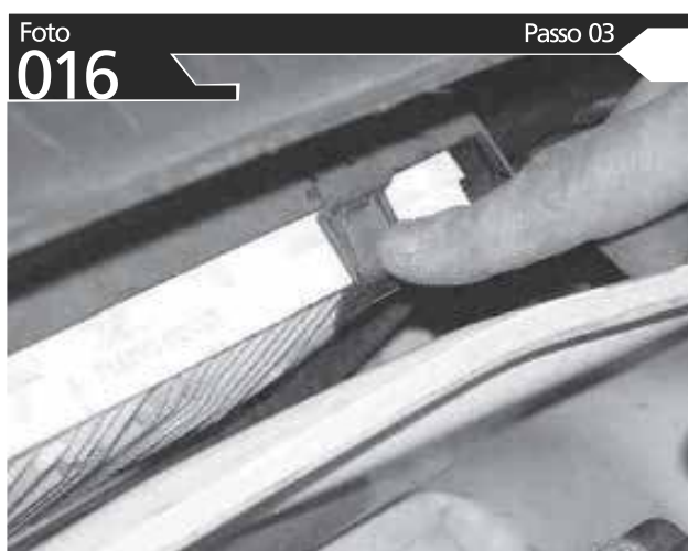
PUXE AS TRAVAS INDICADAS E REMOVA O FILTRO ANTIGO
