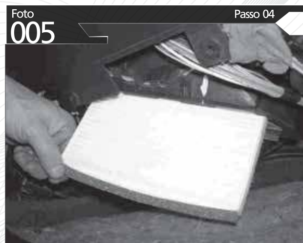
SUBSTITUA O FILTRO USADO E INVERTA AS ETAPAS ANTERIORES PARA MONTÁ-LO
