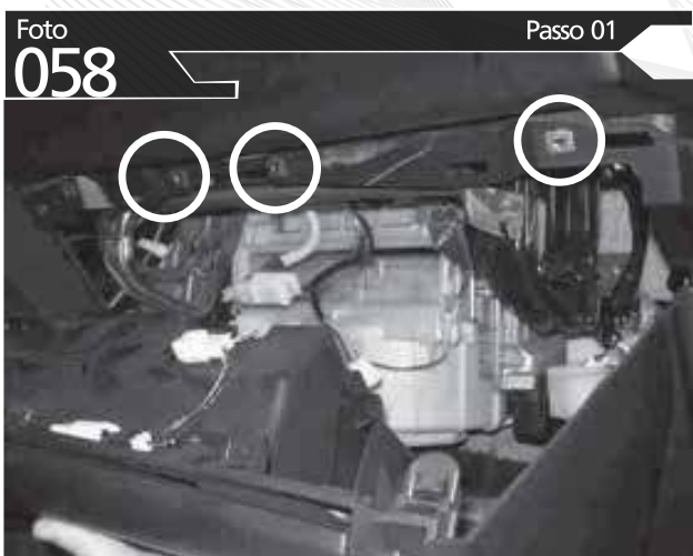
RETIRE OS PARAFUSOS E ABAIXE O PORTA-LUVAS
