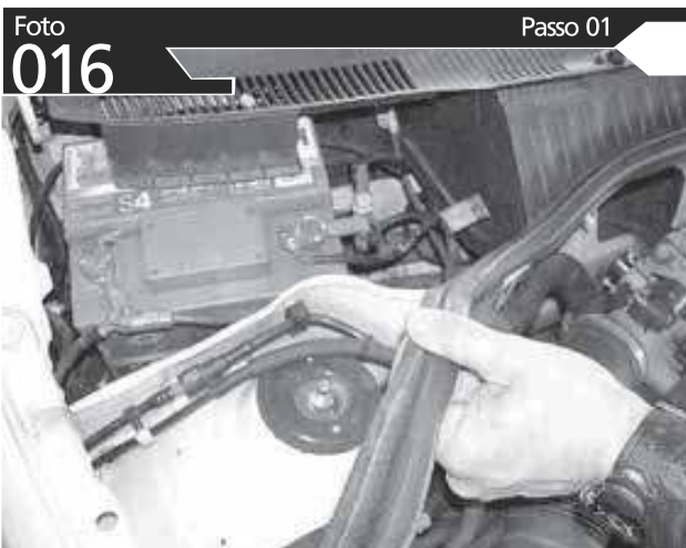
RETIRE A BORRACHA DE VEDAÇÃO SOB O CAPÔ
