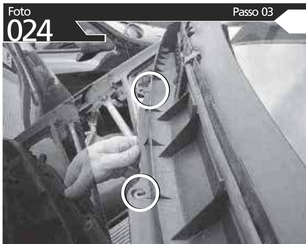
RETIRE A CARENAGEM DE PLÁSTICO
