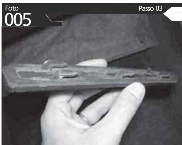
RETIRE A TAMPA MOVENDO-A PARA A DIREITA
