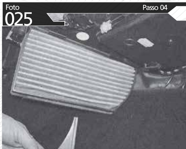
PUXE O FILTRO ANTIGO E FAÇA A TROCA DO FILTRO DE CABINE BACTERIAL
