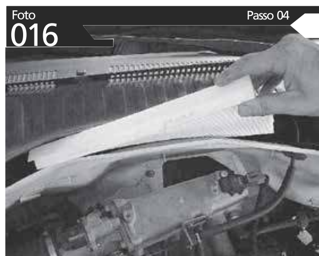
COLOQUE O FILTRO DE CABINE BACTERIAL NOVO E PRESSIONE AS TRAVAS INDICADAS
