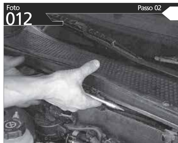
PUXE CUIDADOSAMENTE A CARENAGEM DE PROTEÇÃO E PRESSIONE AS TRAVAS PARA ABERTURA DO ESPAÇO
