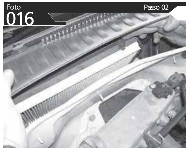
LEVANTE CUIDADOSAMENTE A PROTEÇÃO DE PLÁSTICO SITUADA AO CENTRO DO VEÍCULO SOB O CAPÔ
