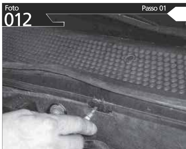
RETIRE A BORRACHA DE VEDAÇÃO SITUADA AO LADO ESQUERDO SOB O CAPÔ E RETIRE O PARAFUSO INDICADO
