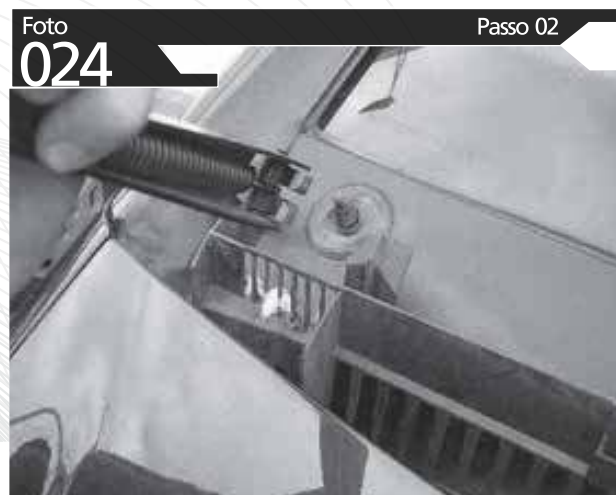
RETIRE O LIMPADOR E OS PARAFUSOS DA CARENAGEM DE PLÁSTICO QUE AINDA RESTAM
