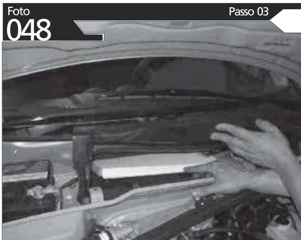
LEVANTE O COMPARTIMENTO DO FILTRO E EFETUE A TROCA
