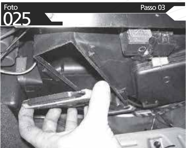
LOCALIZE A TAMPA INDICADA E DESLOQUE AS TRAVAS PARA A RETIRADA DA TAMPA E ENTÃO FAÇA A TROCA
