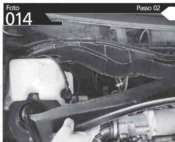
RETIRE A CARENAGEM DE PROTEÇÃO PRESSIONANDO AS TRAVAS INDICADAS
