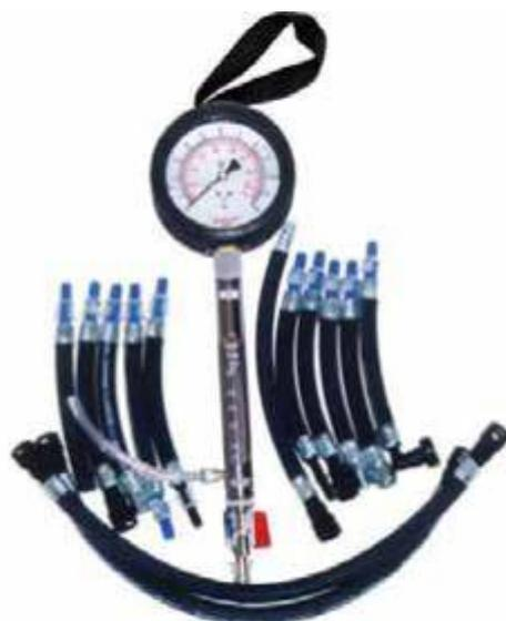
**Nota:** O manômetro de vazão não é recomendado para veículos que possuem regulador de pressão no tanque de combustível.
