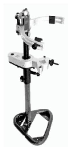
Encolhedor de molas da suspensão dianteira MCPerson de automóveis (molas com diâmetro entre 100 e 206 mm, espessura até 17 mm). Acionamento feito por catraca manual ou chave de impacto pneumática. Não aplicável para C3, vide ferramenta 103305.
