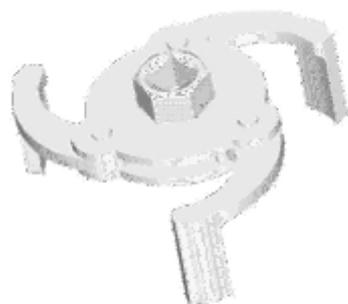
Saca ?ltro de óleo com 3 garras, auto-ajustáveis, e encaixe de 1/2" para cabo de força, ou sextavado de 22 para chave ?xa ou estrela. Diâmetro mínimo de abertura de 70mm e máximo de 100mm.
